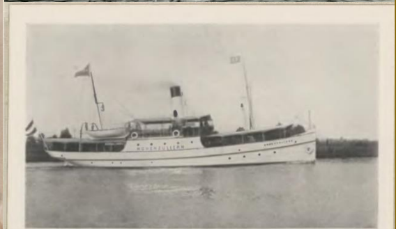
Paffogier- u. Schleppdampfer «Hohenzollern» Erbaut 1907 Klaffe= + 100 \uparrow K (E) Länge = 28 m, Breite = 5,70 m, Seitenhöhe = 3 m Geschwindigkeit = 11 \frac{1}{2} Knoten, 200 Pferdekräften
