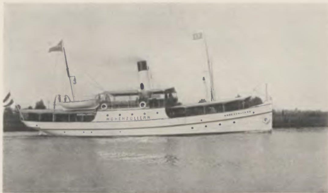
Passagier- u. Schleppdampfer «Hohenzollern» Erbaut 1907 Klasse = + 100 \uparrow K (E) Länge = 28 m, Breite = 5,20 m, Seitenhöhe = 3 m Geschwindigkeit = 11 1/4 Knoten, 260 Pferdestärken
